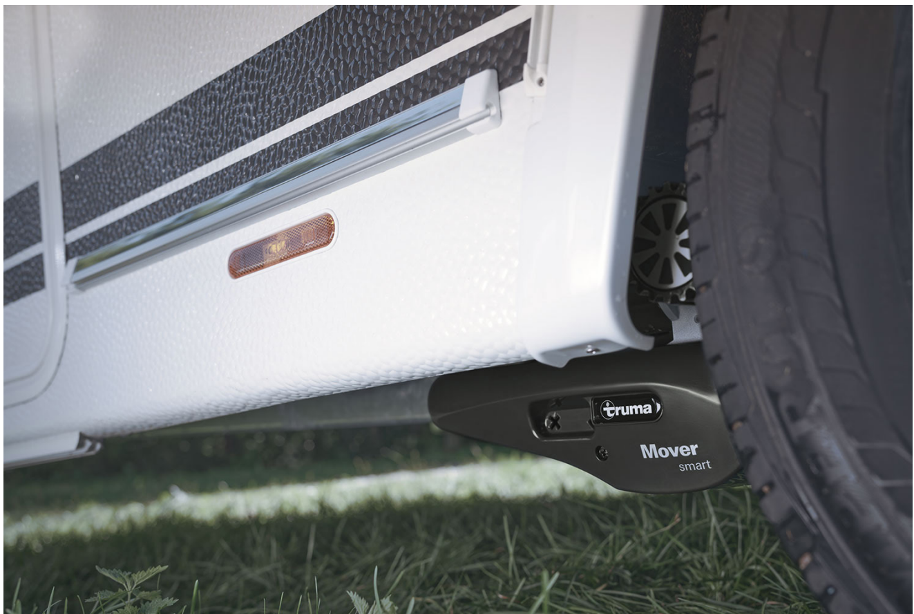
Der Smart Mover ist das Herzstück des Systems – angetrieben von Parvalux-Motoren.
