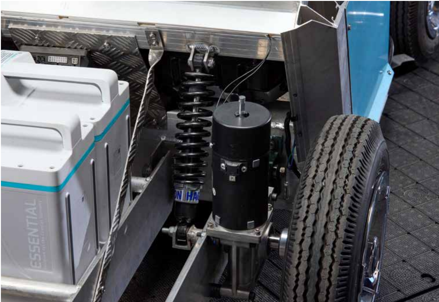
Eine Parvalux-Antriebseinheit zwischen der Aufhängung und dem Rad.
